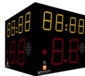
Puissance du signal sonore (120dBa à 1m) : ⚠ la pression acoustique élevée peut créer des troubles auditifs. Les personnes présentes doivent être tenues à une distance raisonnable des afficheurs. Le signal sonore ne dispose pas de réglage de puissance.
